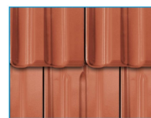
Pokládka na vazbu
