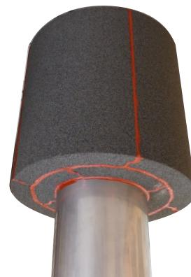
4. Pojistnou folii nebo parozábranu doporučujeme napojit k sestavenému prostupu pomocí oboustranné termostabilní pásky a spoj následně oblepit hliníkovou samolepící páskou (pásy ani folie nejsou součástí výrobku).
