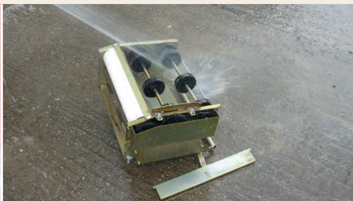
7.3.8 Po ukončení práce maltovací vozík důkladně vyčistěte proudem vody.
