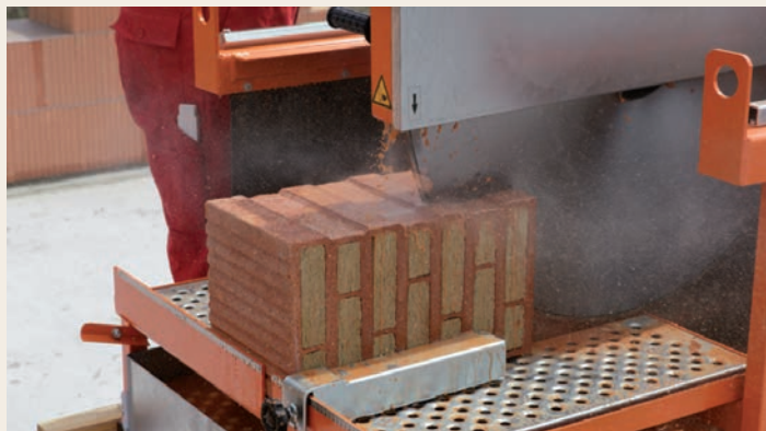
7.8.1 Pilou pro mokré řezání je možné řezat vyrovnávací cihly na libovolnou výšku.
