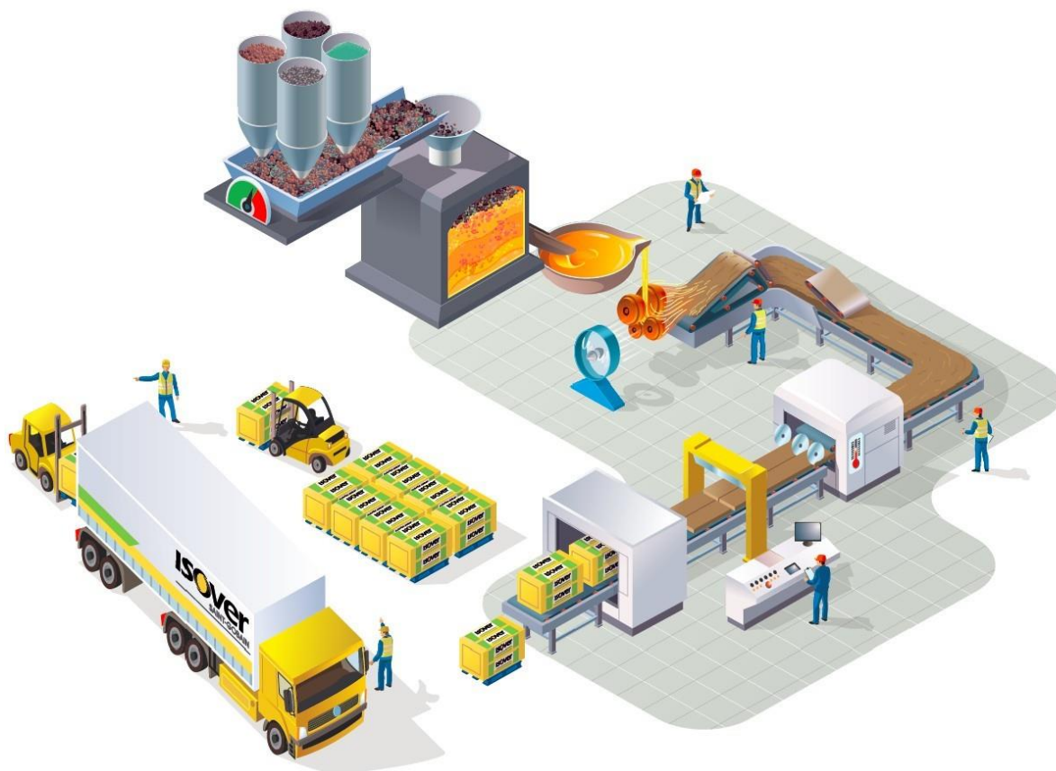
Obr. 3 – Schéma výroby minerální vlny
